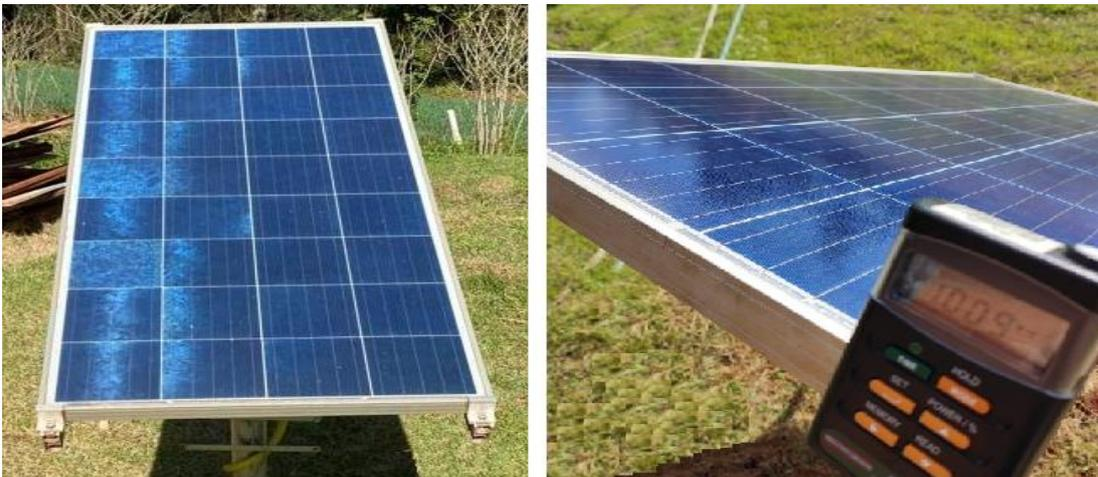
Figura 9 Instalação do módulo fotovoltaico e monitoramento do valor de irradiação paralelamente ao módulo.
