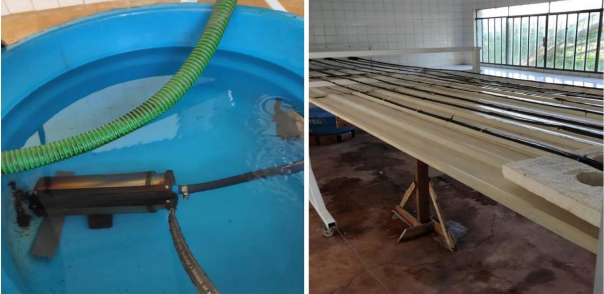
Figura 12 Funcionamento da bomba dentro do reservatório e bancada de ensaio com as 4 linhas de gotejadores em nível.
