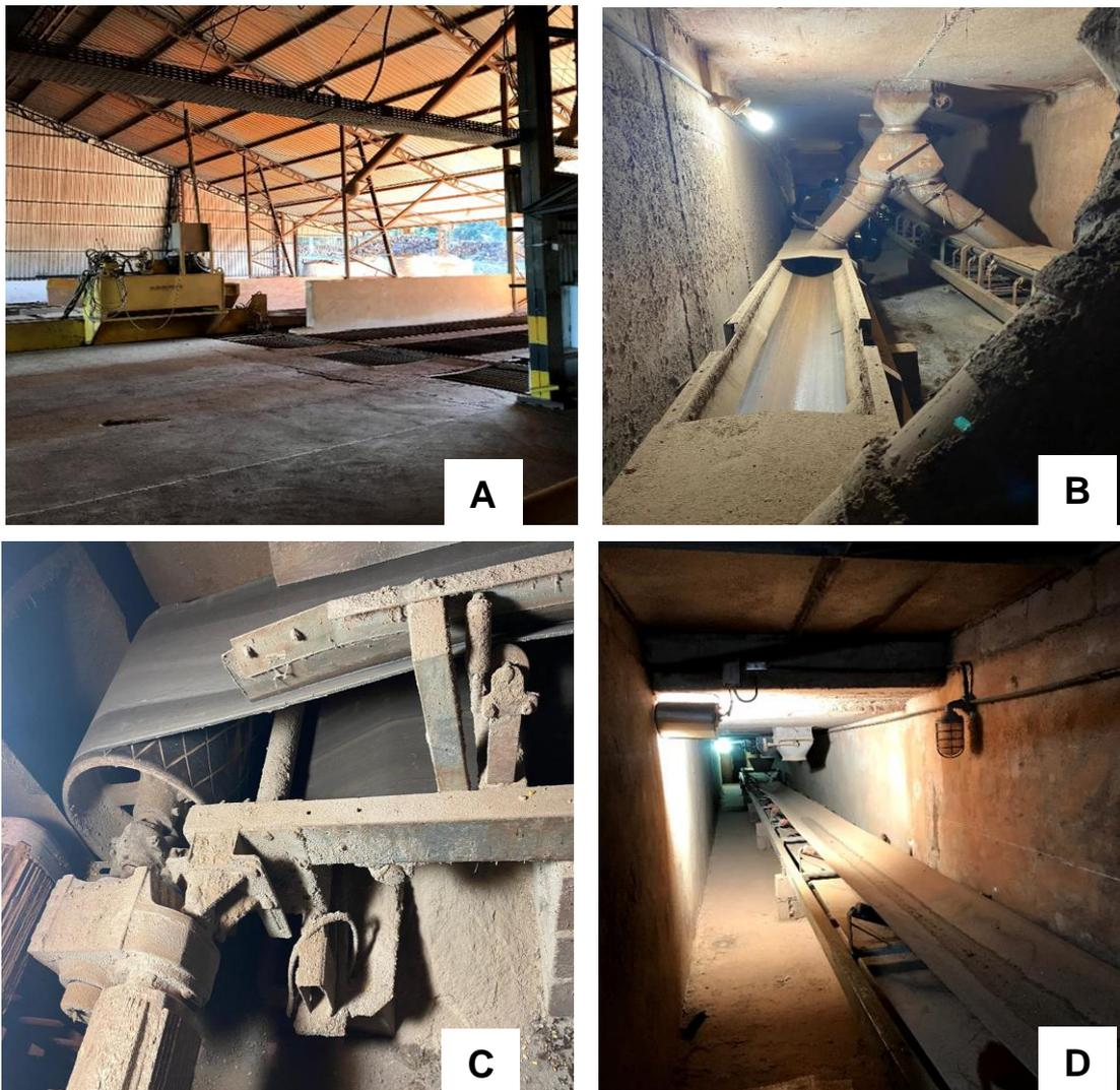
**Figura 7** Registro fotográfico de pontos críticos dentro da unidade armazenadora: (a) visão externa da área de recepção de grãos/moega; (b) base da moega/distribuição dos grãos; (c) base da moega/ detalhe da esteira; (d) fita transportadora - subsolo.
