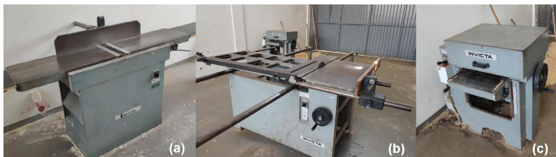
Figura 5 – Desempenadeira (a), serra circular (b) e plaina desengrossadeira (c).
