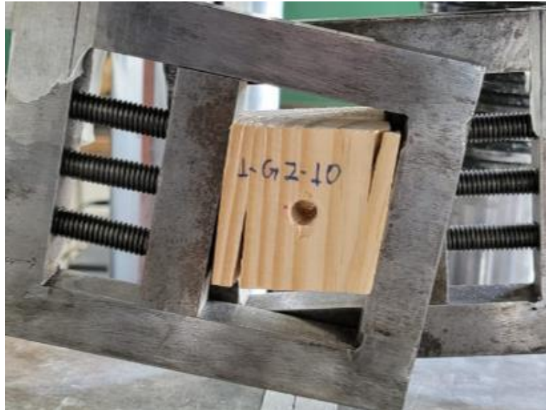
Figura 17 – Fissuração fora do plano colado em corpo de prova submetido ao ensaio de cisalhamento à compressão. Corpo referente ao grupo G2 e ângulo de 10°.
