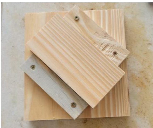
Figura 8 – Colagem em ângulo com contenções laterais.
