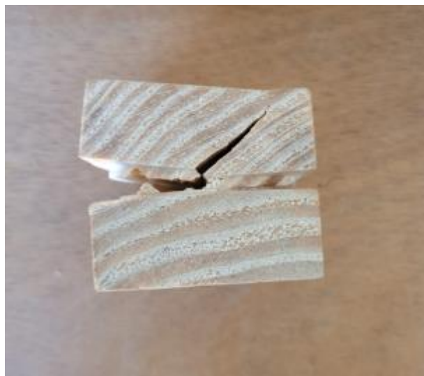
Figura 16 – Fissuração fora do plano colado em corpo de prova submetido ao ensaio de cisalhamento à torção, corpo de prova do grupo G1 e ângulo de 0°.
