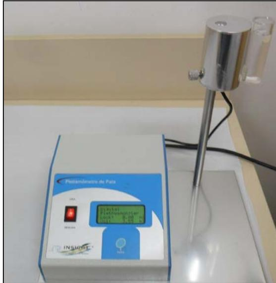
**Figura 6** - Hidropletismômetro de pata da marca insight<sup>®</sup>, para avaliar o edema (Fonte: autora).
