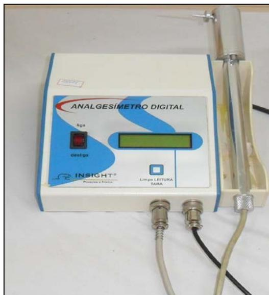
**Figura 3** – Analgesímetro digital tipo filamento de Von Frey (Fonte: autora).
