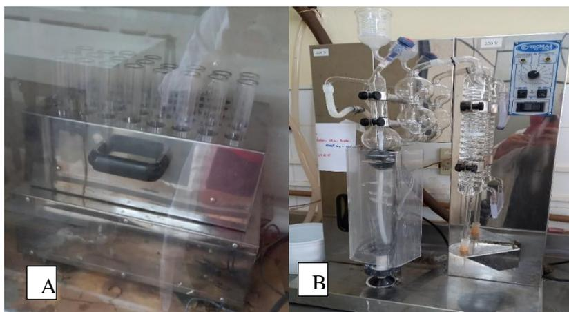
Fonte: fotos do autor: A: Bloco digestor e B: Destilador de nitrogênio
