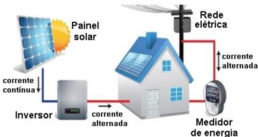
Figura 5 - Dispositivos básicos de um SFVCR. Fonte: CSR Energia Solar (2022)
