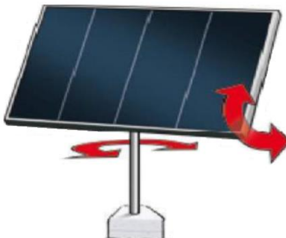
Figura 11 - Sistema de rastreamento de eixo duplo. Fonte: Zakariah et al. (2015)
