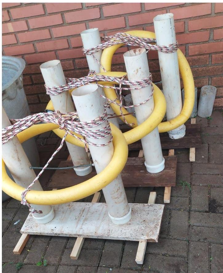
**Figura 10.** Armadilha confeccionada para coleta de sedimentos.
