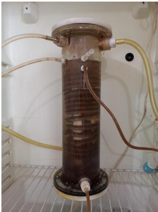
Figura 6 - Reator MABR com 418 dias de operação no tratamento de água residuária de abatedouro de aves.
