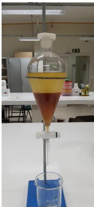
**Figura 4.4.** Formação de duas fases, a superior contendo biodiesel e a inferior contendo glicerol.
