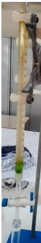
**Figura 5.11.** Arraste da clorofila na coluna cromatográfica com extrato de erva mate.
