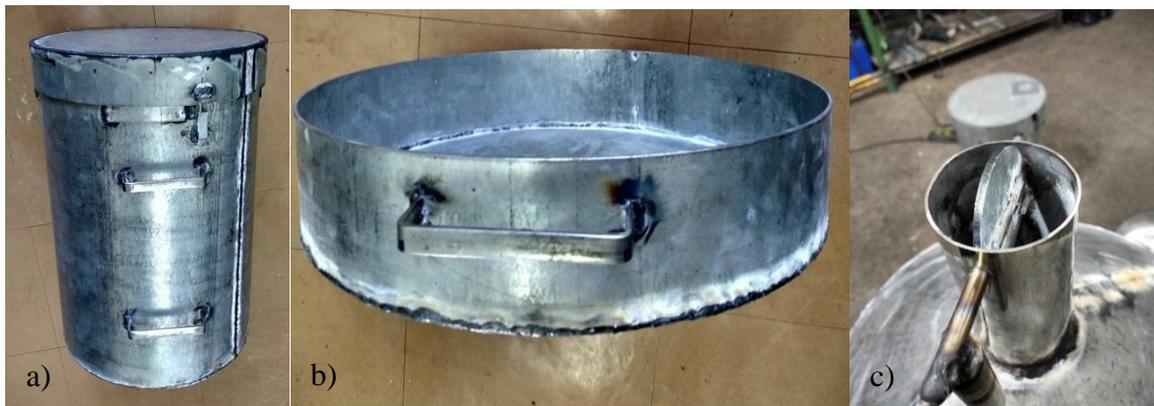
Figura 4.23. Detalhes das peças finalizadas: a) tanque interno; b) bandeja; c) válvula manual da chaminé. Fonte: autoria própria.
