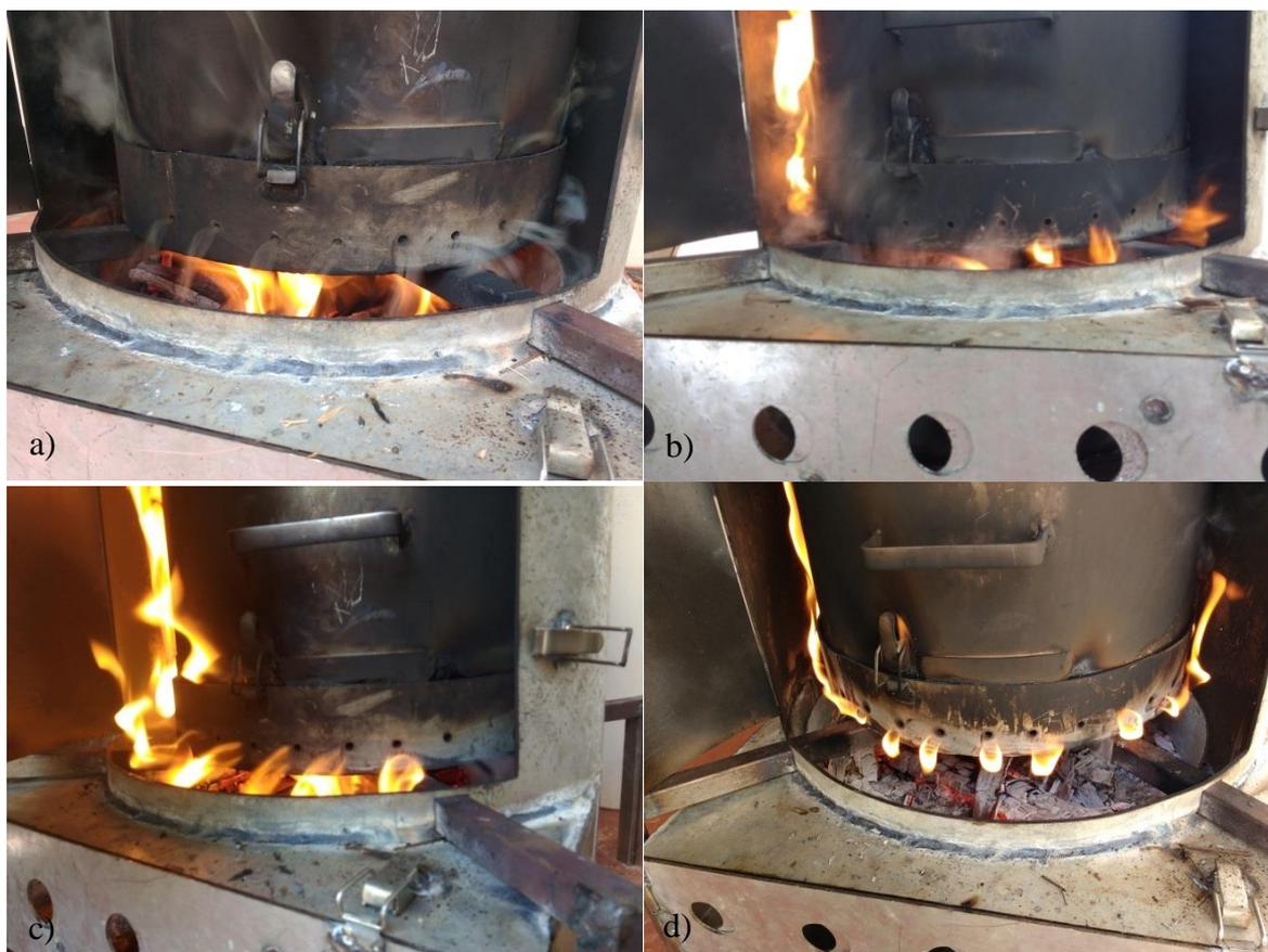
Figura 4.34. Estágios observados durante procedimento experimental: a) liberação de mistura de gases não combustível; b) início da combustibilidade; c) chama forte e constante; d) diminuição da liberação dos gases combustíveis. Fonte: autoria própria.
