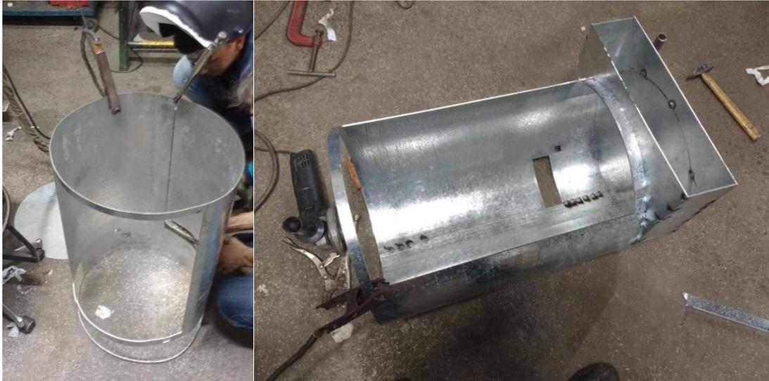
Figura 4.22. Montagem e soldagem da tecnologia proposta. Fonte: autoria própria.
