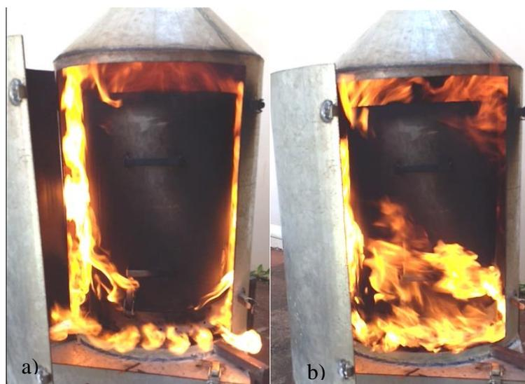
Figura 4.35. Sistema com chama constante: a) sem utilização do soprador; b) com sistema do soprador ligado, aumentando circulação dos gases no sistema. Fonte: autoria própria.
