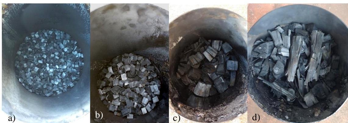
Figura 4.36. Material lenhoso após a carbonização na tecnologia desenvolvida: a) batelada 1 (20mm); b) batelada 2 (40mm); c) batelada 4(60 mm); d) batelada 7 (sem fragmentação). Fonte: autoria própria.
