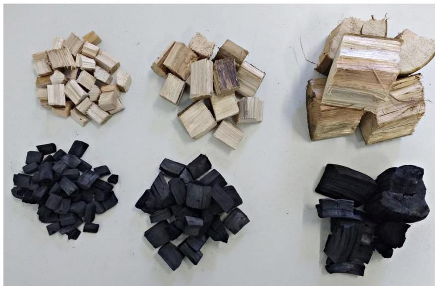
Figura 4.37. Amostras de madeira e do carvão gerado por cada uma das granulometrias avaliadas. Fonte: autoria própria.
