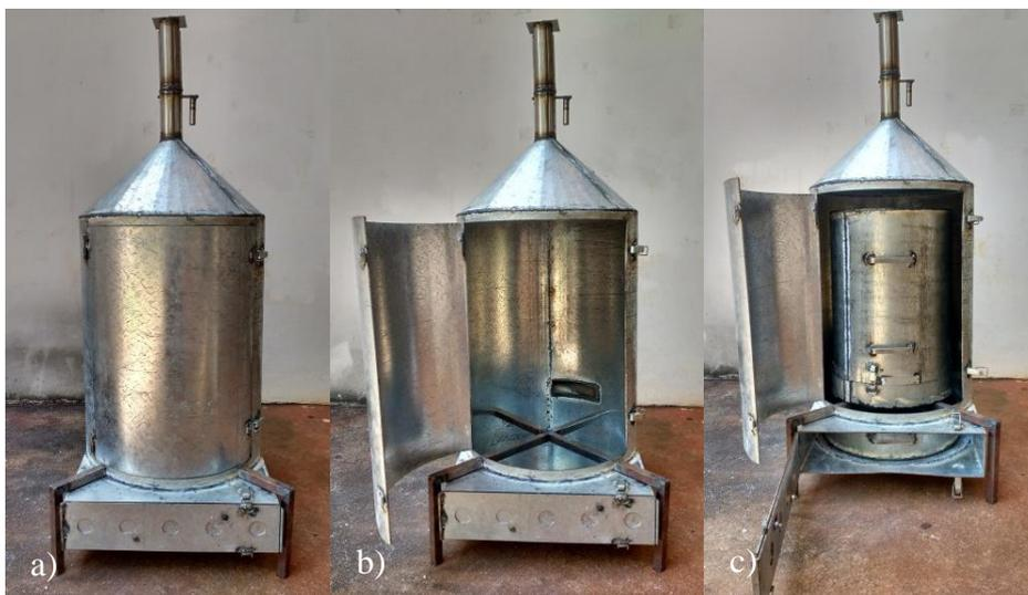
Figura 4.25. Equipamento montado: a) fechado; b) com porta aberta; c) com portas abertas e tanque interno e bandeja inseridos. Fonte: autoria própria.
