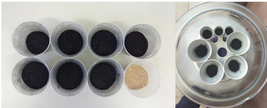
Figura 4.41. Amostras do carvão gerado trituradas e peneiradas. Fonte: Autoria própria.
