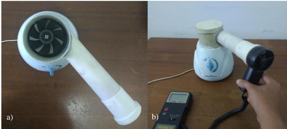
Figura 4.27. Montagem do soprador com bocal de saída: a) vista superior; b) medição de velocidade média do ar com anemômetro. Fonte: autoria própria.
