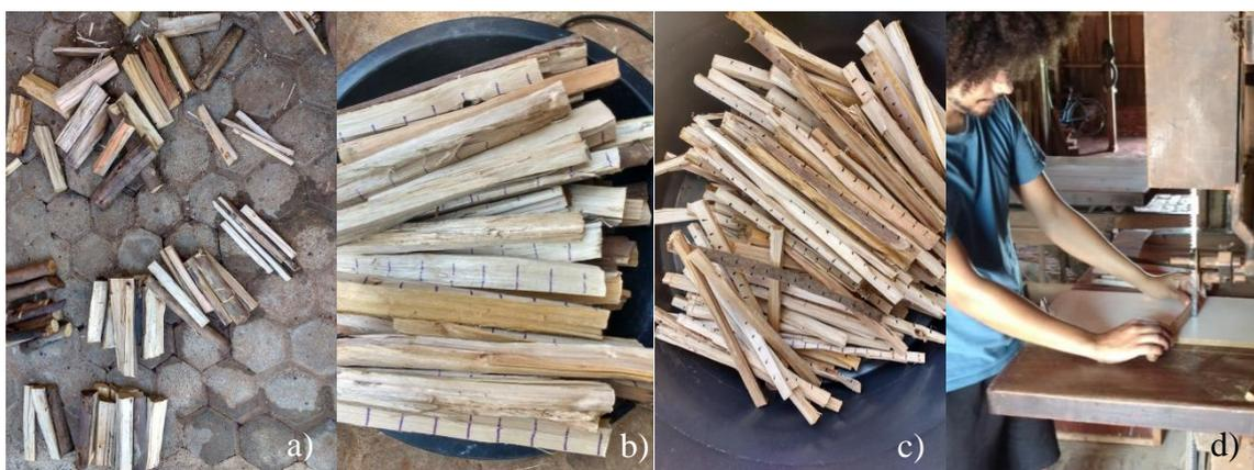
Figura 4.29. Preparação das amostras de lenha para os experimentos. Fonte: autoria própria.
