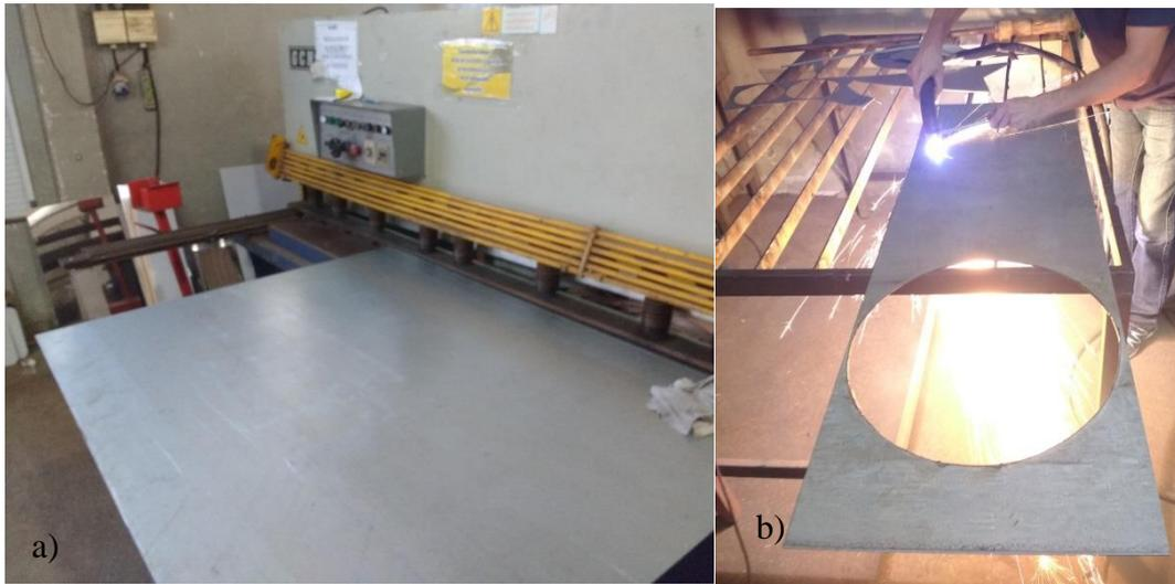
Figura 4.20. Corte das chapas de aço: a) em guilhotina industrial; b) em máquina de corte plasma. Fonte: autoria própria.
