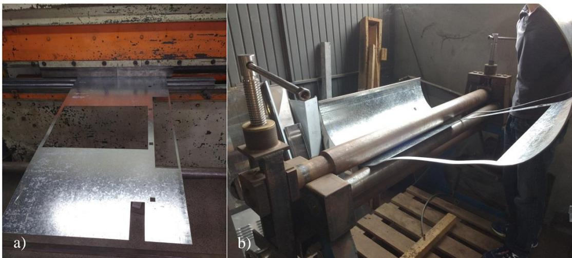
Figura 4.21. Conformação das partes cilíndricas utilizando: a) dobradora industrial; b) calandra simples motorizada para chapas. Fonte: autoria própria.
