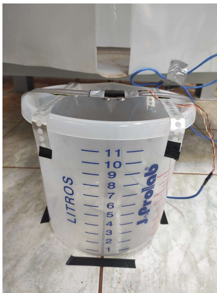
Figura 24. Sensor ultrassônico para medir o volume de água.
