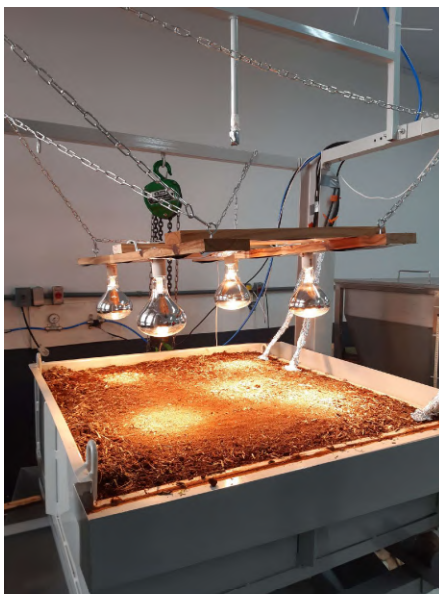
Figura 28. Secagem da caixa de solo com lâmpadas infravermelhas.
