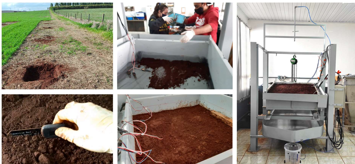
Figura 26. Processo da construção da caixa de solo com sensores de umidade.
