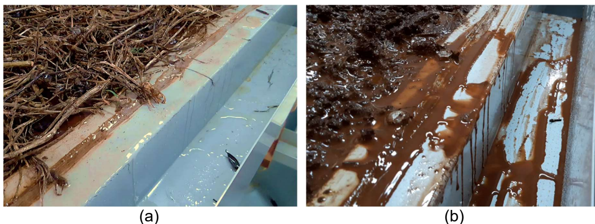
Figura 38. escoamento na calha com solo coberto (a) e descoberto (b).
