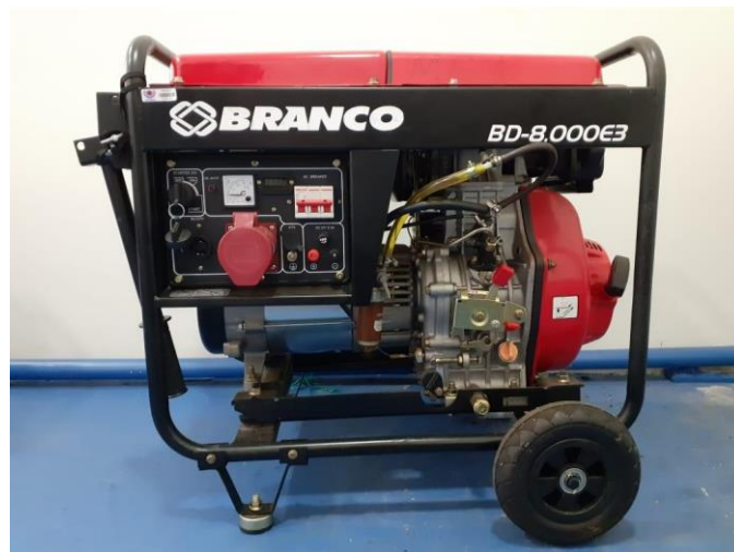
Figura 7: Conjunto Motor Gerador. Fonte: AUTOR. (2022).
