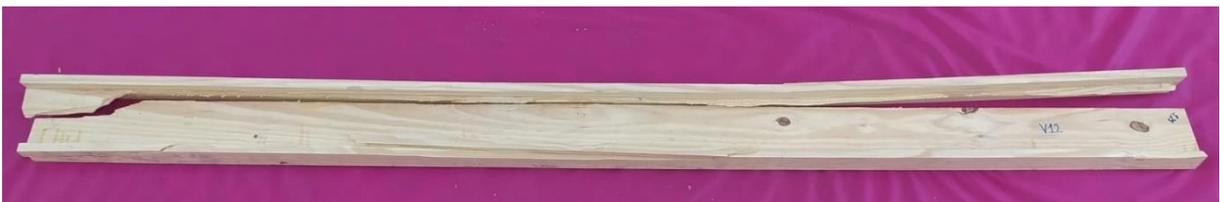
Figura 31 – Viga V21 após a ruptura.
