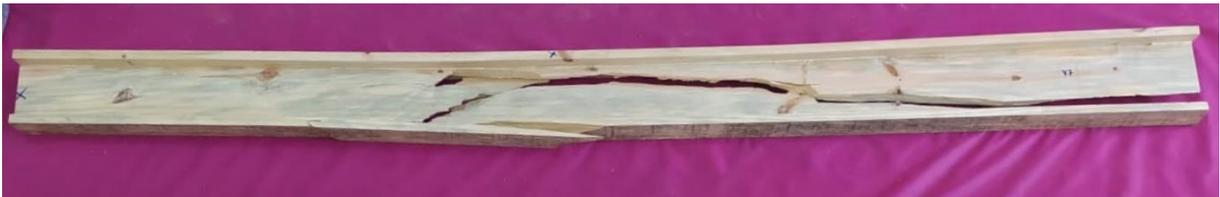
Figura 39 - Viga V7 após a ruptura.
