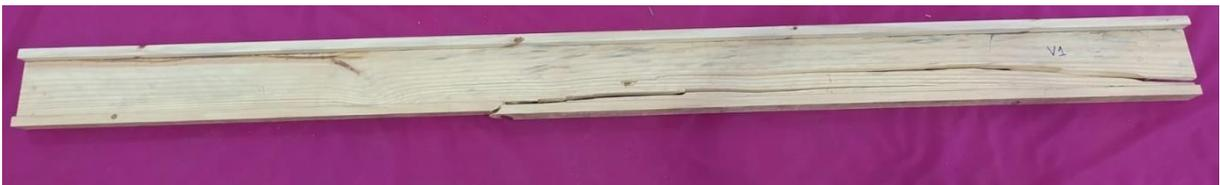
Figura 45 - Viga V1 após a ruptura.
