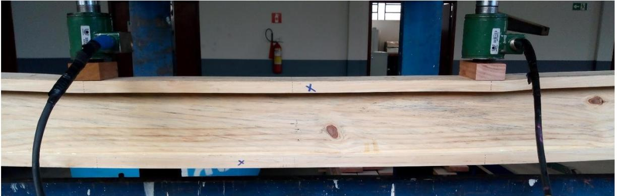
Figura 33 – Detalhe do defeito na alma da viga V4 e fibras da lâmina superior sofrendo esmagamento.
