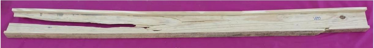
Figura 54 - Viga V20 após a ruptura.
