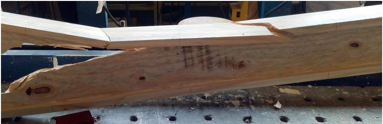
Figura 36 - Detalhe da ruptura por compressão na mesa superior da viga V2.
