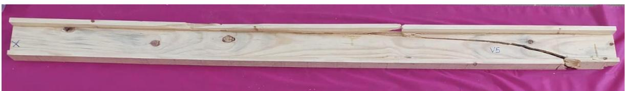
Figura 35 – Viga V5 após a ruptura.
