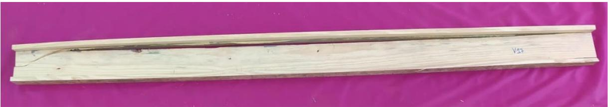
Figura 52 - Viga V17 após a ruptura.
