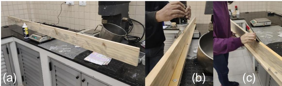
Figura 22 – Alma posicionada na balança para mensuração do adesivo na face superior da alma (a), aplicação do adesivo (b) e espalhamento do adesivo na face inferior da alma (c).
