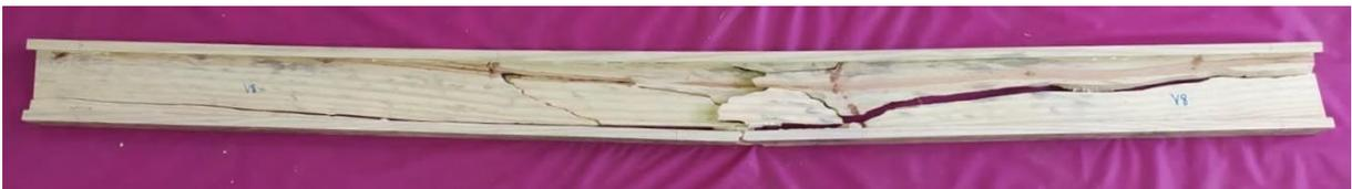
Figura 40 - Viga V8 após a ruptura.
