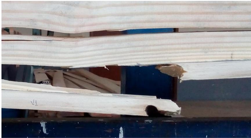
Figura 44 - Detalhe do defeito na viga V1.
