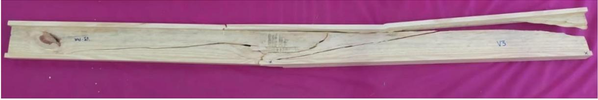
Figura 38 - Viga V3 após a ruptura.
