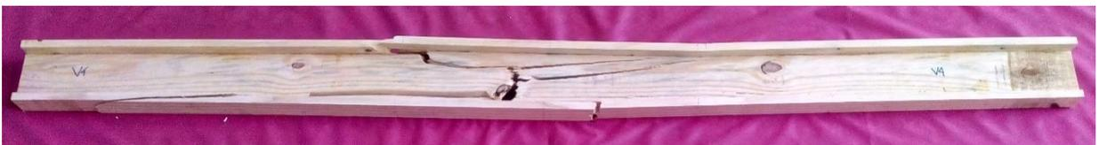
Figura 34 – Viga V4 após a ruptura.
