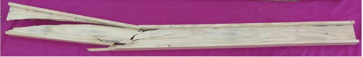
Figura 51 - Viga V15 após a ruptura.
