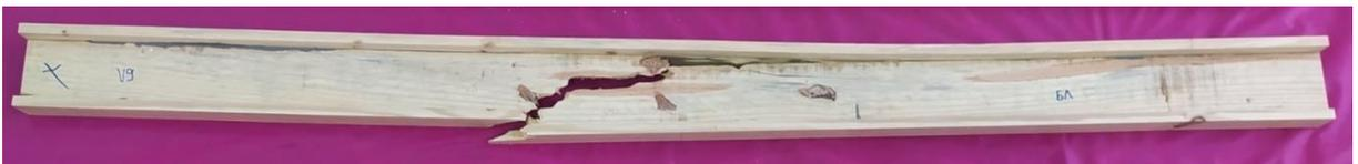
Figura 49 - Viga V9 após a ruptura.
