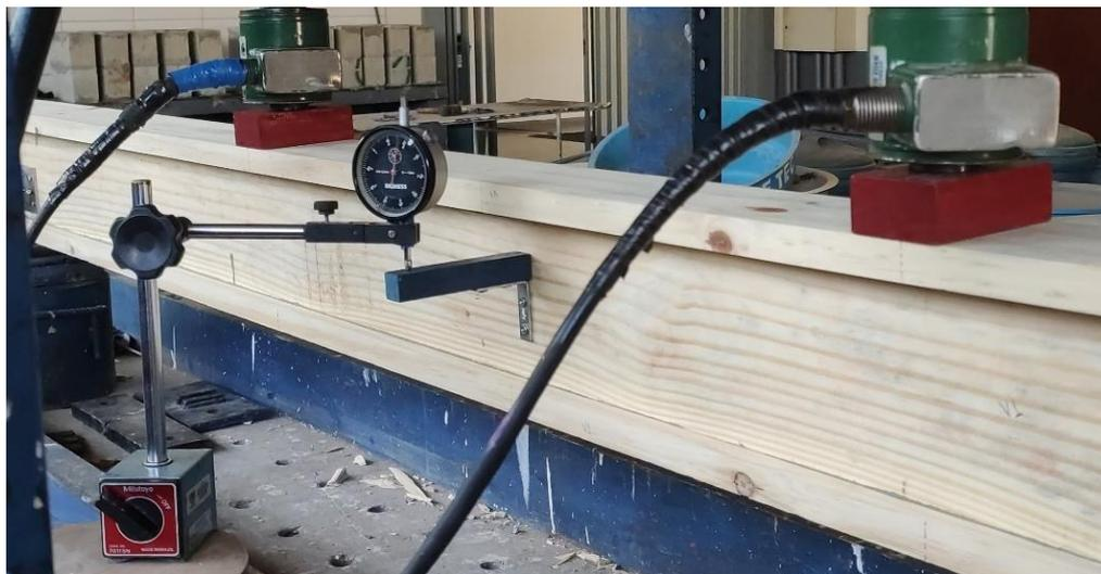
Figura 27 - Relógio instalado no meio do vão.
