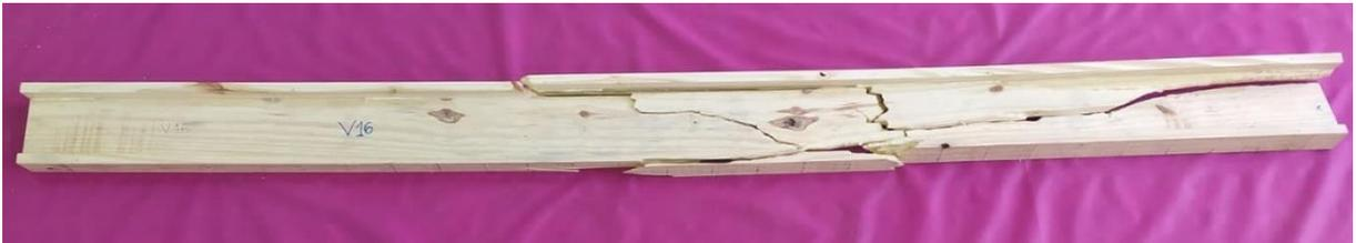
Figura 43 - Viga V16 após a ruptura.
