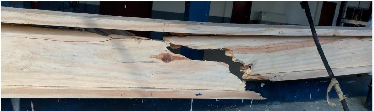
Figura 48 - Detalhe do defeito da viga V9.
