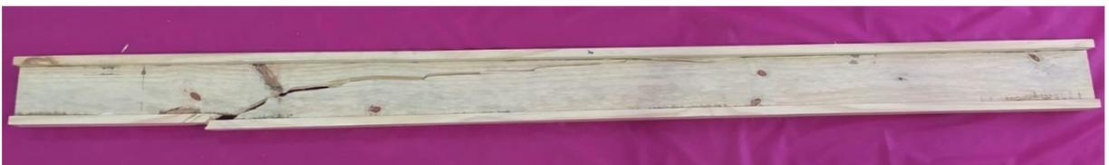
Figura 50 - Viga V11 após a ruptura.
