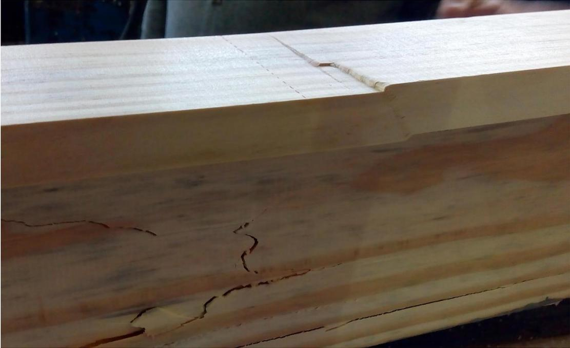
Figura 53 - Detalhe de esmagamento por compressão das fibras da mesa superior da viga V20.
