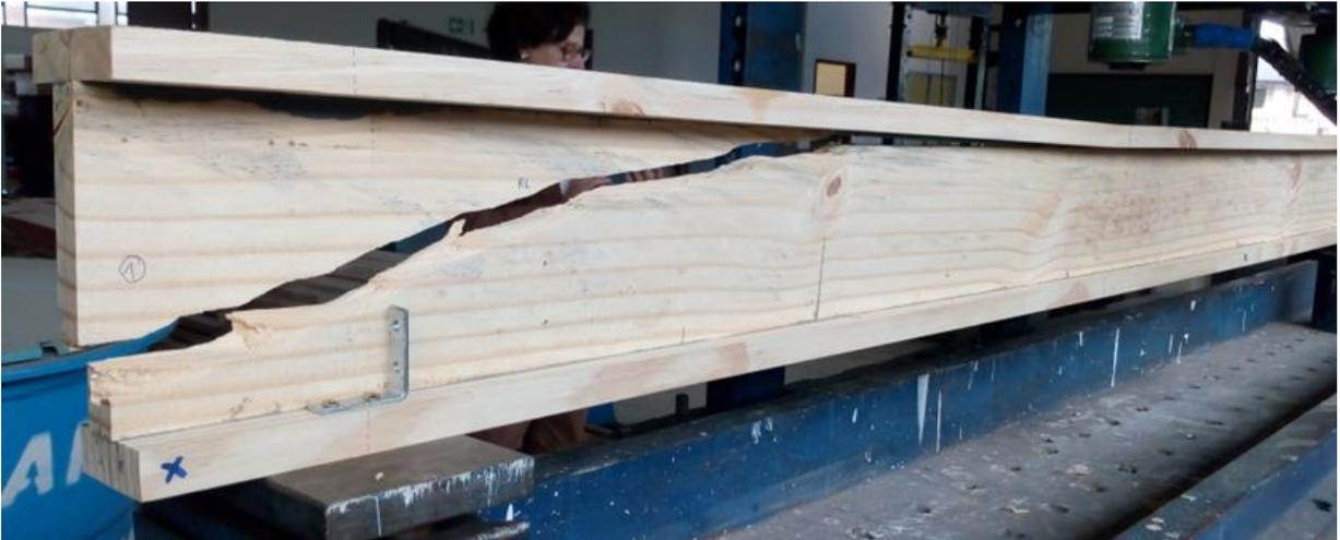
Figura 46 - Detalhe da ruptura da viga V6.
