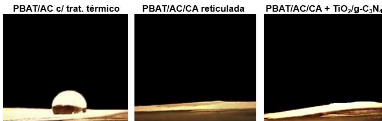
Figura 5.17: Imagens de ângulo de contato para as fibras poliméricas de PBAT/AC c/ tratamento térmico; PBAT/AC/CA reticulada; PBAT/AC/CA c/ 5% de \text{TiO}_2/\text{g-C}_3\text{N}_4 .
