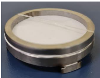
Figura 8: Suporte esférico de aço inox para fixação da membrana.
