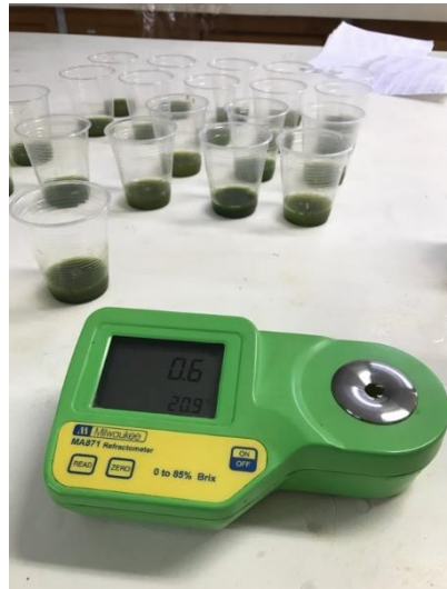
Figura 4 - Medição de sólidos solúveis em amostra de folhas de rúcula
