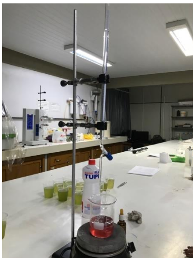
Figura 6 - Titulação com NaOH para determinação de acidez titulável em amostra de folhas de rúcula
