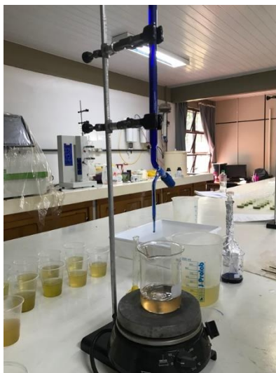
Figura 7 - Titulação com DEFIN para determinação de vitamina C em amostra de folhas de rúcula
