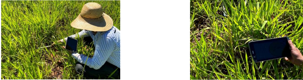
Figura 7. Equipamento Plant Canopy Imager CI-100 realizando coletas de índice de área foliar, ângulo foliar e interceptação luminosa.
