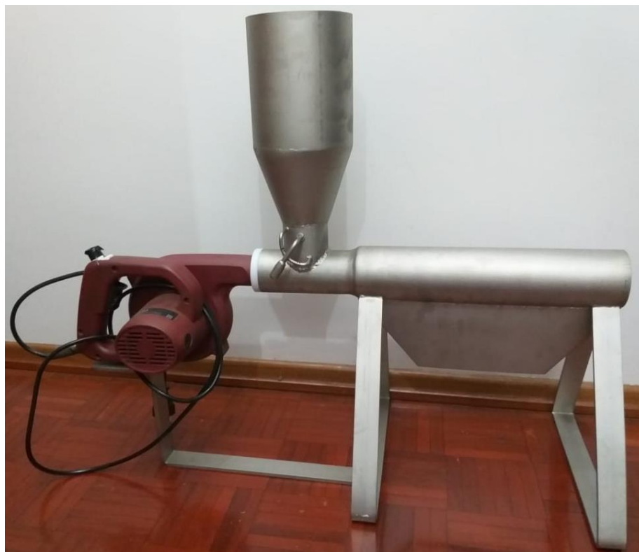
Figura 4.4.2: Protótipo de câmara gravitacional utilizado na separação de impurezas e grãos de trigo, construído em escala piloto (Fonte: o autor).
