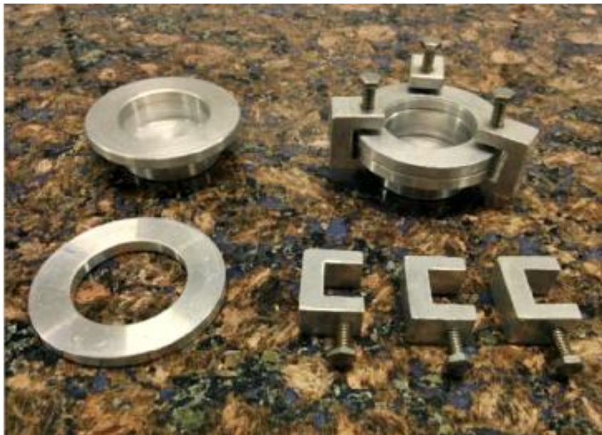
Figura 5 Cúpulas de permeabilidade.
