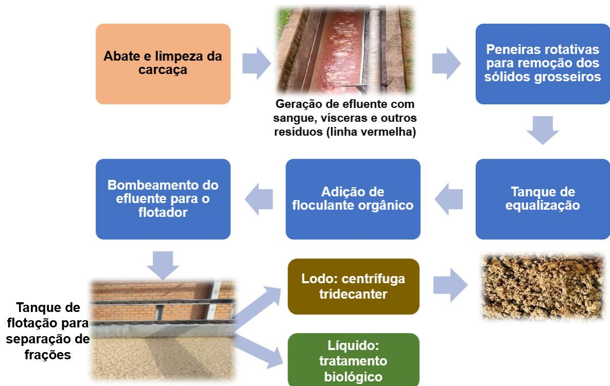
Figura 8 Esquema ilustrativo da geração do lodo de flotador em abatedouro de frangos de corte.
