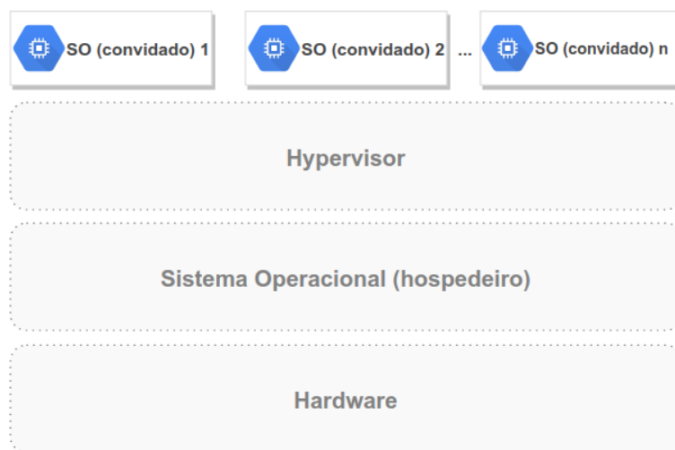
Figura 3 – Arquitetura de Máquinas Virtuais de categoria “Tipo 2”. Adaptada de (PRASAD, 2014)
