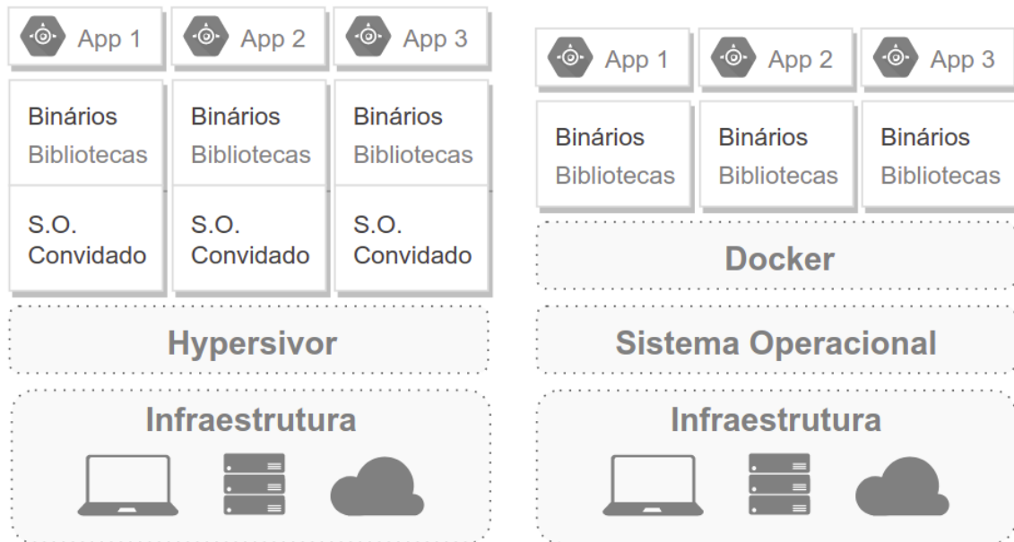
Figura 4 – Arquitetura de máquinas virtuais em hypervisor versus contêineres. Adaptada de (YADAV; GARG; MEHRA, 2019)
