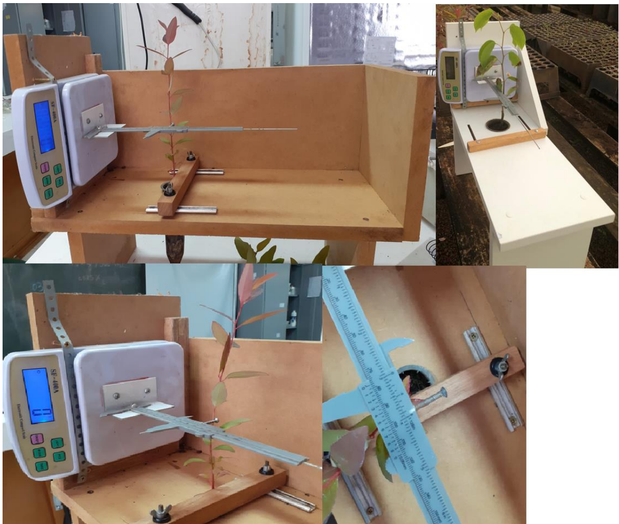
Figura 1- Equipamento adaptado para a quantificação da rigidez flexural em mudas de Eucalyptus urograndis e Hymenaea courbaril
