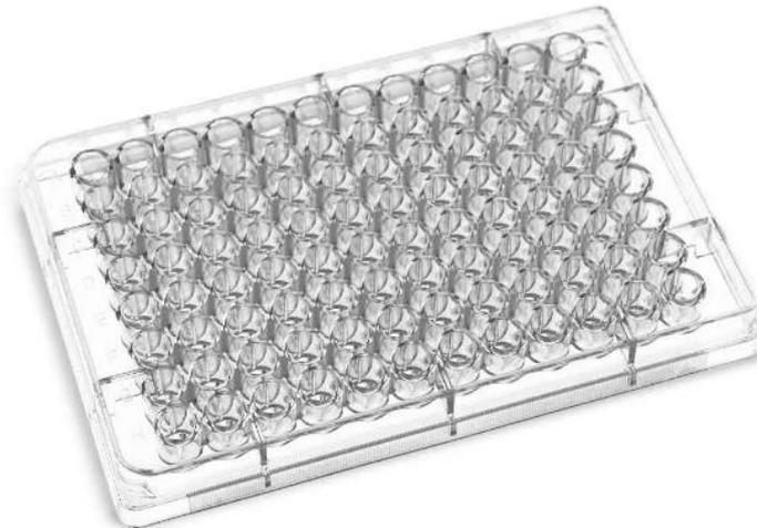
**Figura 16:** Modelo de Microplaca Marca Corning estéril, transparente de 96 poços com fundo chato, onde o teste de microdiluição foi realizado. (Fonte: Corning.com)
