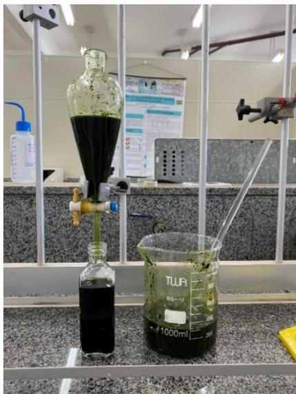
**Figura 18.** Extração por percolação. Ao lado esquerdo, funil de vidro de percolação e frasco para recepção e armazenamento do extrato hidroalcoólico e, ao lado direito, béquer contendo material seco e solvente. (Fonte: Dados do autor)
