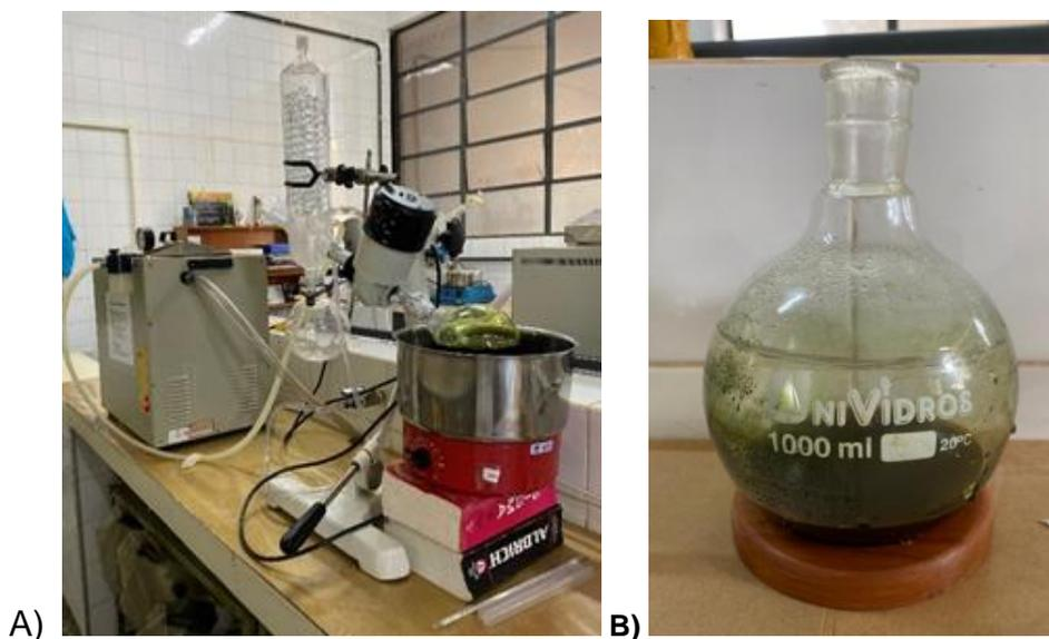
**Figura 20.** A) Rotaevaporador da marca Quimis, modelo Q-355J, em processo de uso, para a primeira etapa de secagem do extrato. B) Extrato fluido rotaevaporado. (Fonte: Dados do autor)
