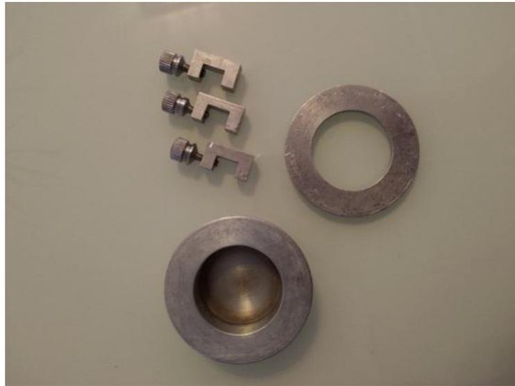
Figura 1 Cúpula de Permeabilidade utilizada para estudo de transmissão de vapor de água.
