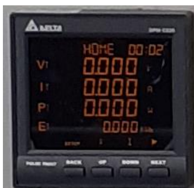
Figura 22. Medidor multifuncional de parâmetros elétricos DPM-C520.
