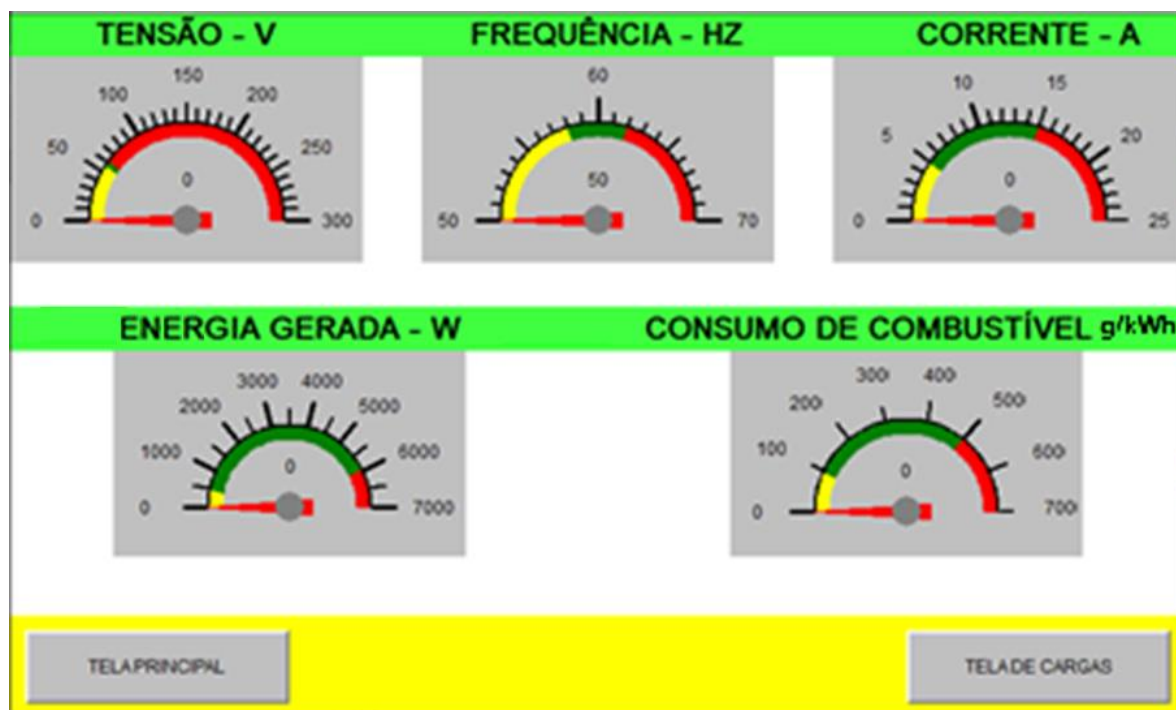
Figura 21. Tela com os medidores de tensão, frequência, corrente, energia e consumo de combustível.
