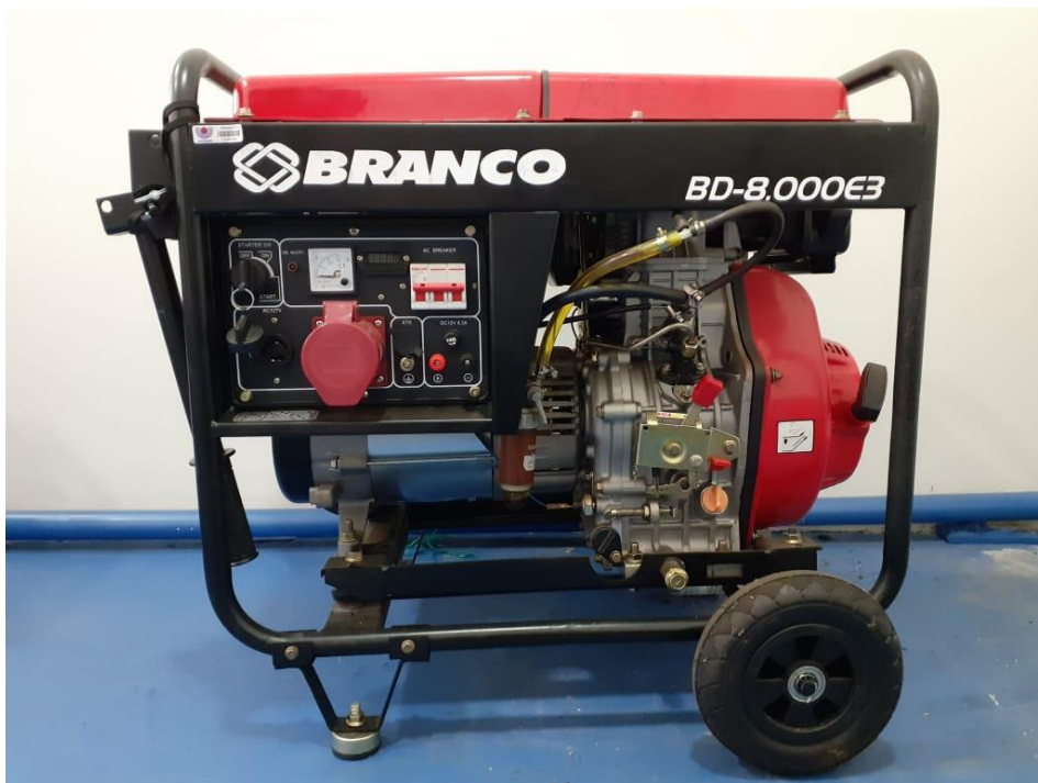
Figura 15. Conjunto motor gerador.
