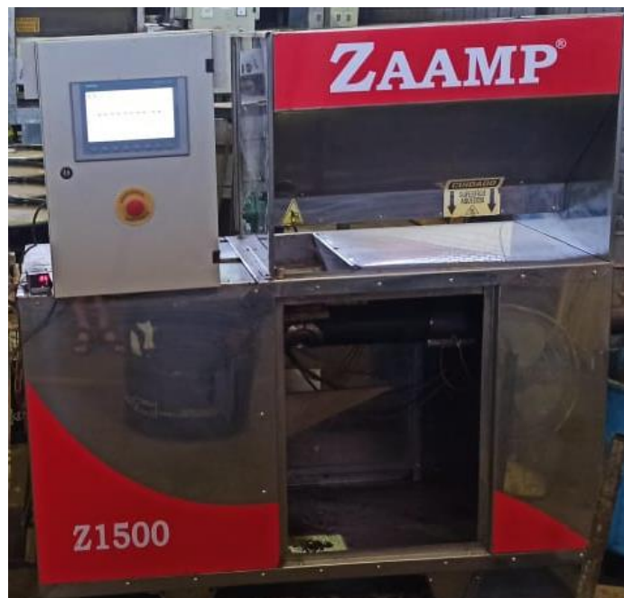
Figura 31. Prensa extrusora de óleo.
