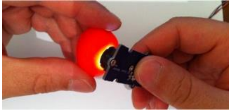
Figura 25 Leitura de tomate cereja com protótipo Arduino (Nunes, 2015)
