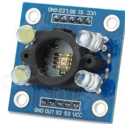
Figura 8 Equipamento de sensoriamento de comprimentos de onda da luz visível TCS3200 (TAOS, 2011)
