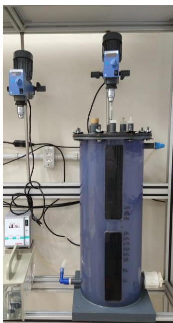
Figura 15 Reator CSTR em escala de bancada alimentado com fração sólida de dejetos suíno e carcaça suína.
