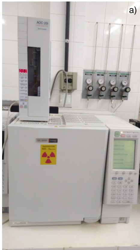
Figura 16. Equipamentos para determinação de fipronil em mel: a) GC-ECD (Shimadzu GC-2010; b) Coluna capilar dimethyl polysiloxane Rtx® Restek.
