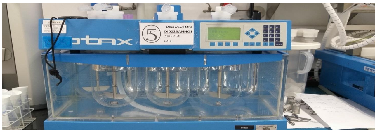
Figura 4.3.1: Dissolutor para a liberação de ibuprofeno com concentração teórica de 8,5 mg de fármaco.
