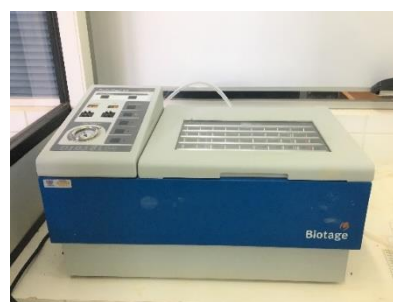
Figura 18 a) Condicionamento dos cartuchos SPE C18 1000 mg/6 mL conectados a um Minifold para a realização de extração de fipronil em mel; b) Coleta dos extratos eluídos das amostras de mel em tubos de ensaios; c) Secagem dos extratos eluídos das amostras de mel em fluxo de nitrogênio; d) Equipamento TurboVap® LV com fluxo de nitrogênio.
