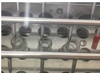
Figura 18 a) Condicionamento dos cartuchos SPE C18 1000 mg/6 mL conectados a um Minifold para a realização de extração de fipronil em mel; b) Coleta dos extratos eluídos das amostras de mel em tubos de ensaios; c) Secagem dos extratos eluídos das amostras de mel em fluxo de nitrogênio; d) Equipamento TurboVap® LV com fluxo de nitrogênio.
