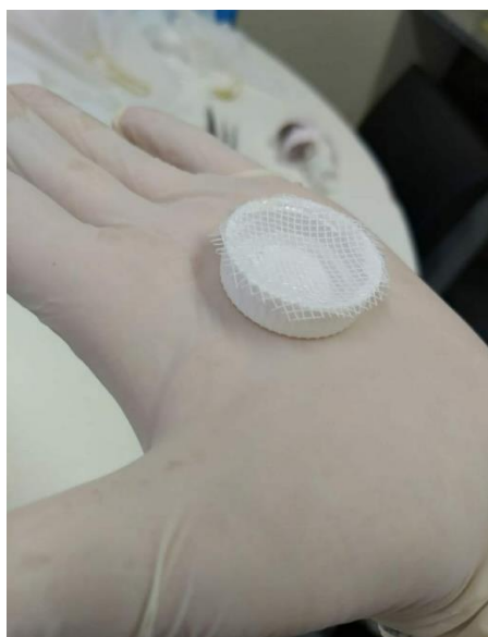
Figura 3 Recipientes de plásticos com tela antiafídica, para oferecimento da dieta alimentar de cada tratamento do inseticida imidacloprid para abelhas A. mellifera .
