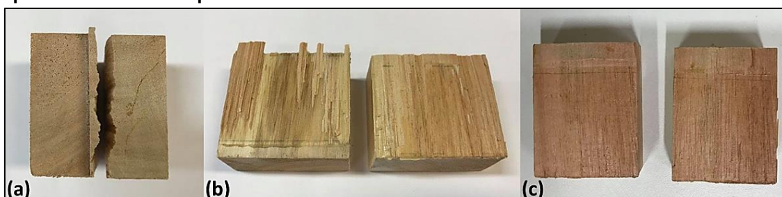
Figura 33: Eficiência da linha de cola; (a) Linha de cola com rompimento na madeira; (b) Linha de cola com quebra juntamente da madeira e adesivo; (c) Linha de cola em que apenas o adesivo rompeu.
