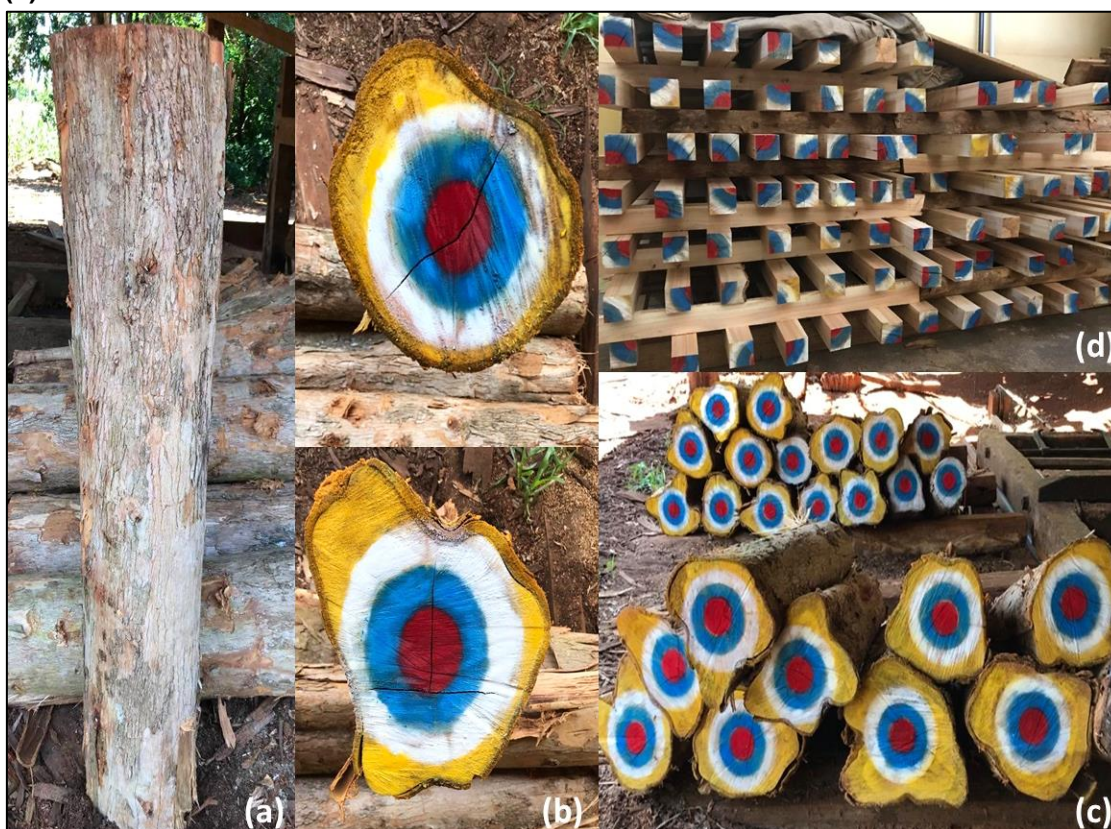
Figura 9: Demarcação do fuste (a); Seção de corte (b); Peças identificadas com fuste já demarcados (c); Caibros empilhados para secagem com as demarcações de localização (d).
