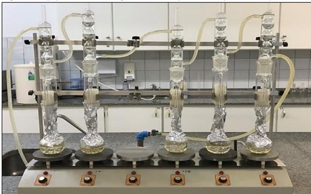
Figura 10: Equipamento de extração soxhlet acoplado no dispenser de aquecimento.
