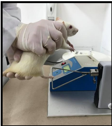
Figura 11 - Foto ilustrativa do aparato para avaliação da força de preensão. Momento em que o animal está com o membro pélvico na grade. Fonte: Autora, 2019.
