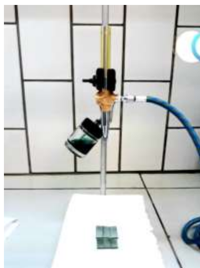
Figura 20. Método de deposição por aerografia. FONTE: Autora, 2021.
