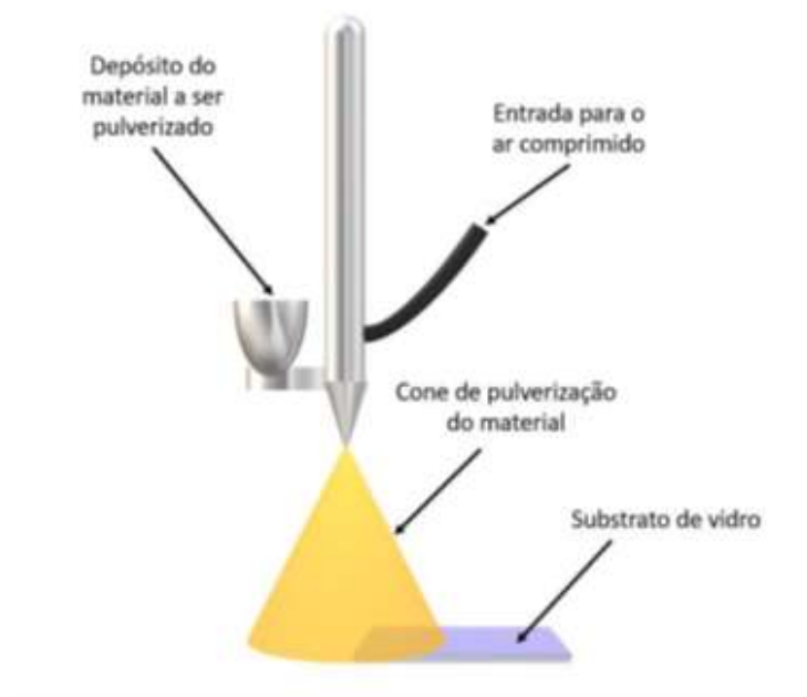
Figura 18: Método de deposição em spray com a utilização de um aerógrafo expelindo material sobre um substrato [46].
