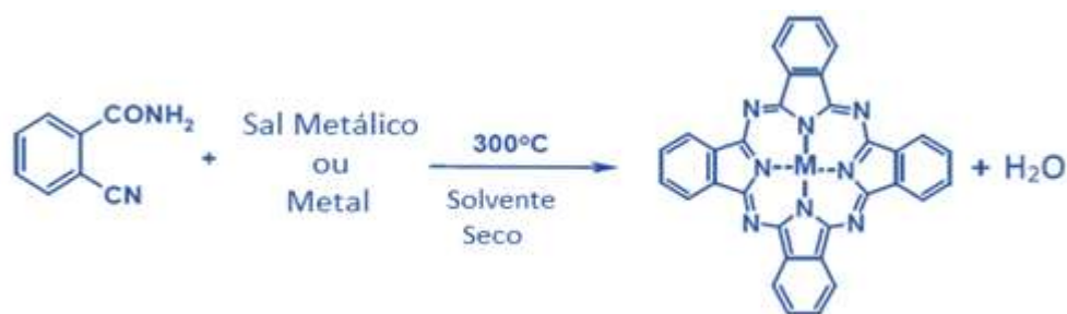
Figura 1 – Ftalocianina metálica a partir do reagente orto-cianobenzamida Fonte: Autora, 2021.
