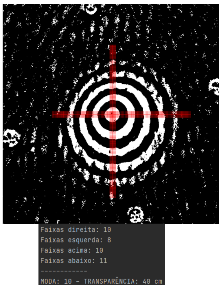
Figura 6 – Extração de ponto de interesse, binarização e contagem de faixas em imagem de cone listrado utilizado como referência para análise de transparência de corpos d'água em ambiente de piscicultura por meio de RPAS
