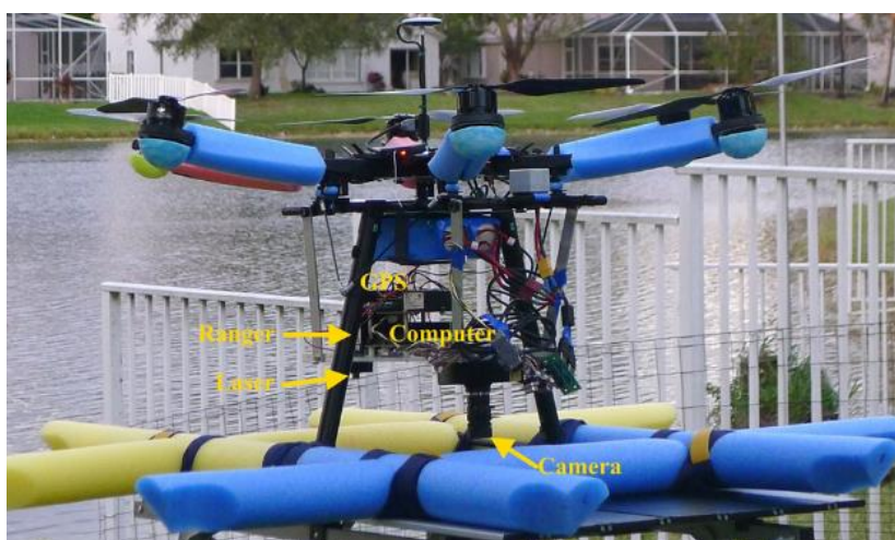
Figura 12 – Veículo aéreo remotamente pilotado adaptado por Shen et al. (2017) para batimetria de lagoas
