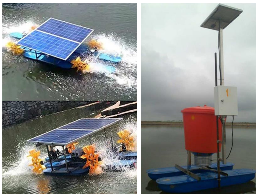
Figura 16 – Aeradores e alimentadores autônomos
