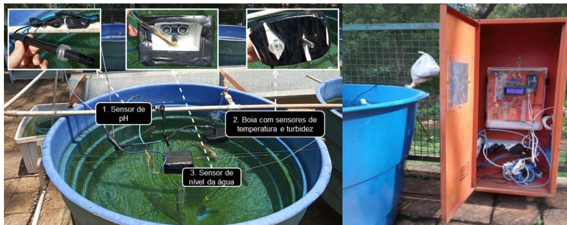
Figura 5 – Protótipo de medição de qualidade da água utilizando Arduino desenvolvido por Santos et al. (2019).
