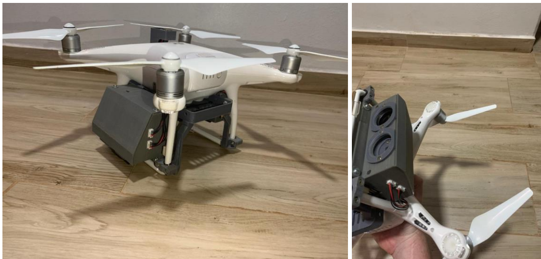
Figura 3 – Equipamento projetado para captura de imagens em ambiente de piscicultura por meio de uma RPAS
