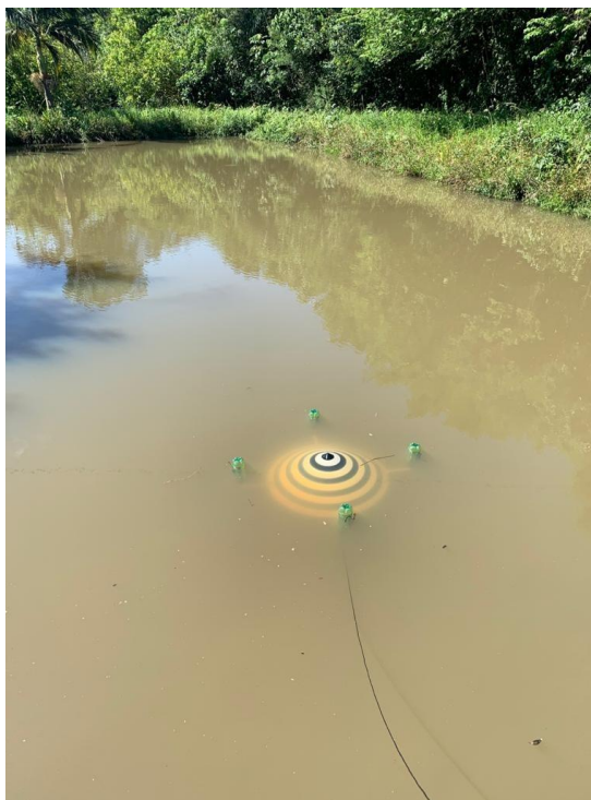
Figura 4 – Cone de referência para imagens aéreas, para fins de análise de transparência de corpos d'água em ambiente de piscicultura
