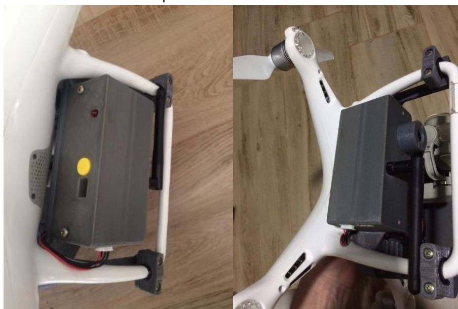
Figura 3 - Módulo sensor de temperatura infravermelho acoplado a um RPAS para medição de temperatura em viveiros escavados de piscicultura
