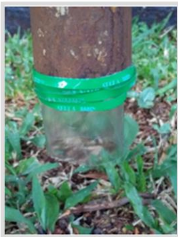
Figura 9 - Saída coletor de água protótipo
