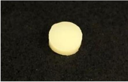
Disco de cimento de ionômero de vidro com 2 mm de altura e 8 mm de diâmetro interno.
