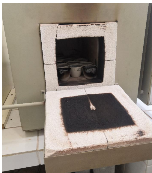
Figura 13 – Mufra utilizada para combustão da amostra seca Fonte: A autora.
