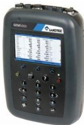
Figura 14 - Monitor de gás portátil modelo Landtec GEM 5000 Fonte: QED Environmental Systems, Inc.
