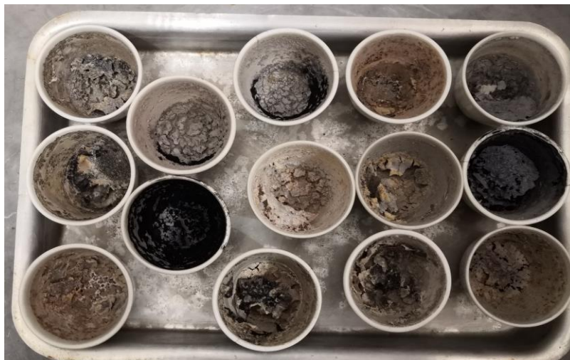
Figura 20 – Cinzas das amostras após processo de secagem e combustão em mufla Fonte: A autora.
