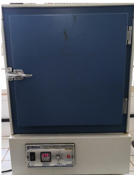
Figura 12 - Estufa com recirculação de ar para remoção de água das amostras Fonte: A autora.
