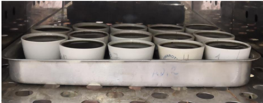
Figura 19 - Amostras de substratos em processo de secagem utilizando estufa com recirculação de ar Fonte: A autora.
