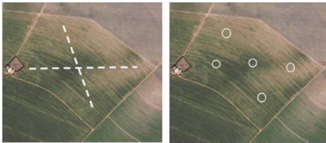
Figura 2 - Disposição dos pontos a serem amostrados em formato de X ou seguindo o número 5 de um dado, para metodologia do método manual de amostragem.
