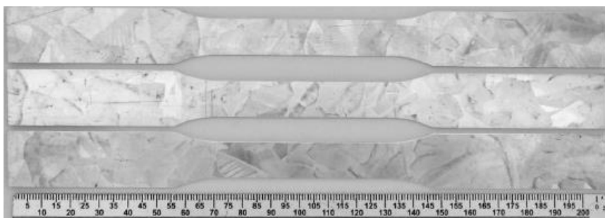
Figura 29 Corpo de prova para ensaio à tração.
