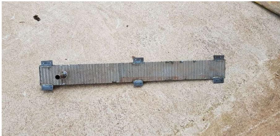
Figura 21 Dispositivo de coleta do ar de aeração.
