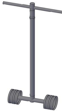
Figura 2 - Implemento manual desenvolvido para uniformizar a distribuição das doses dos polímeros hidroabsorventes nos sulcos do plantio, confeccionado pela própria Autora, junto ao Programa de Pós-graduação em Agronomia da UNIOESTE, Paraná-Brasil, 2019.
