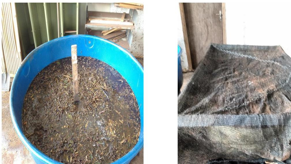
Figura 4 Tanque de equalização (a) e sistema de SF (b).
