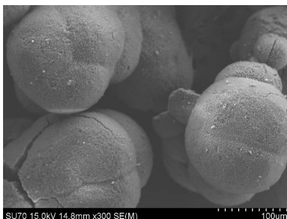
Figura 58: Imagem obtida por microscopia eletrônica de varredura com ampliação de 300 vezes do produto da síntese de \text{Mg}^{2+} e BPTC na razão ligante:metal de 1:2 em pH 4.
