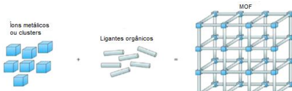
Figura 3.2: Representação das porções orgânica e inorgânica dos MOFs. Adaptado de Gu et al. , 2017.
