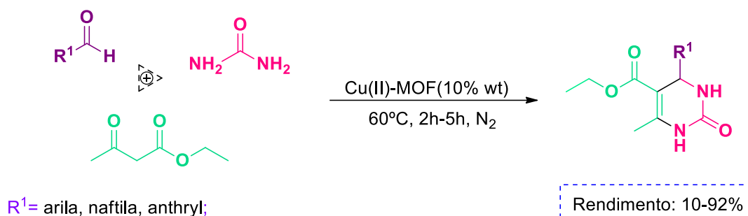
Esquema 3.13: Reação de Biginelli catalisada por Cu(II)-MOF
