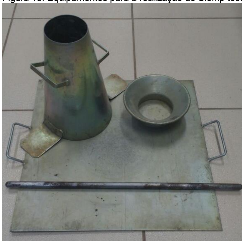
Figura 13. Equipamentos para a realização do Slump test.
