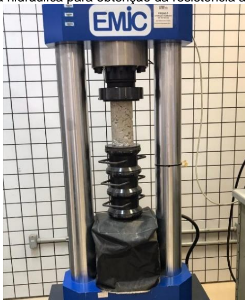
Figura 18. Prensa hidráulica para obtenção da resistência a compressão.
