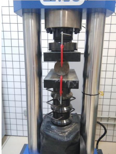
Figura 19: Ensaio de tração por compressão diametral.
