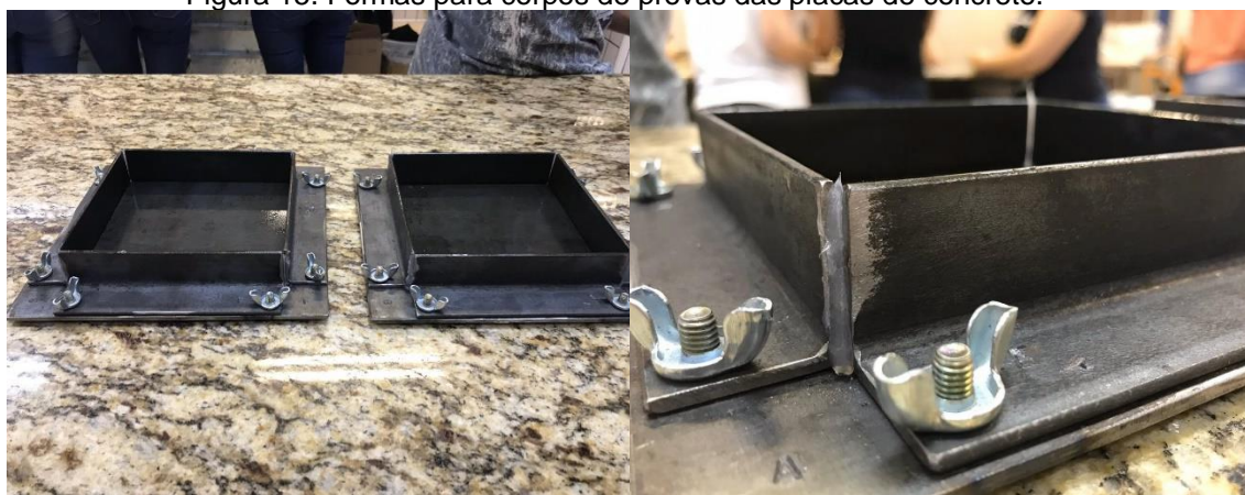
Figura 15. Formas para corpos de provas das placas de concreto.
