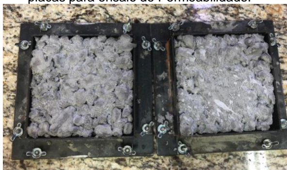
Figura 16: Concreto fresco nos moldes de placas para ensaio de Permeabilidade.
