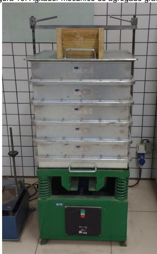
Figura 10: Agitador mecânico do agregado graúdo.
