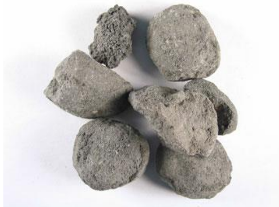
Figura 5: Clínquer para a fabricação de cimento.
