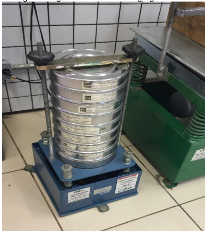
Figura 10: Agitador mecânico do agregado graúdo.
