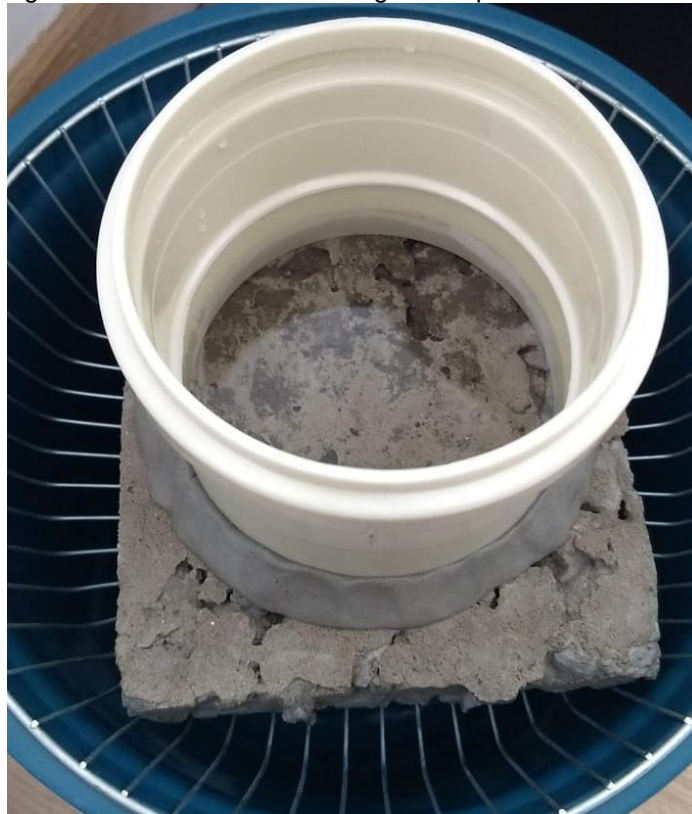
Figura 28: Permeabilidade da água nas placas de concreto.
