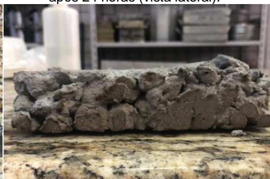
Figura 17: Placa de concreto desmoldada após 24 horas (vista lateral).
