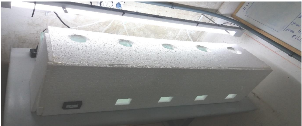
Figura 4 - Barreira confeccionada de isopor para isolar os aquários experimentais utilizados nos ensaios de atrato-palatabilidade.
