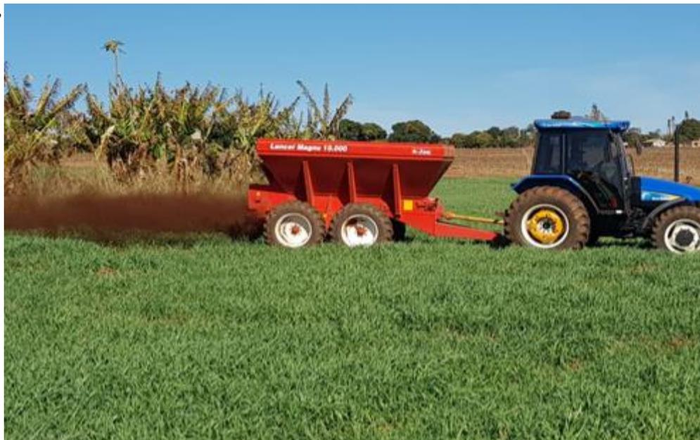
**Figura 4.** Aplicação a lanço, com auxílio de implemento do fertilizante orgânico produzido a partir de carcaças de frango.
