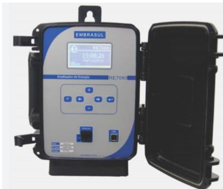
Figura 25 – Analisador de grandezas elétricas RE7000.
