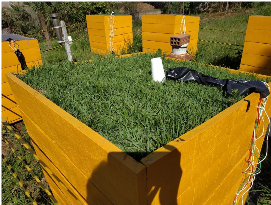
Figura 10: Protótipos instalados no Campo experimental da Universidade Estadual do Oeste do Paraná, com sensores já implementados.
