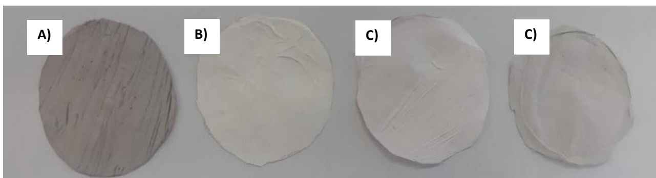
Figura 9: Imagens das membranas: (a)Ecovio® com 1% de OFM (b)Ecovio® com 10% de TiO 2 -R, (c)Ecovio® pura, (d)Ecovio® com 10% de TiO 2 e 1% de OFM.
